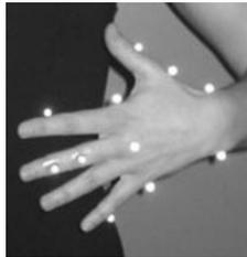
Les petits marqueurs sur la main et le corps permettent de mesurer les déplacements des doigts les uns par rapport aux autres, par rapport au corps et par rapport à l'espace.
